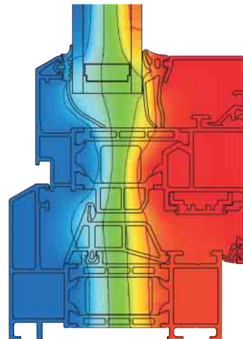
Schüco Окно AWS 70 RL.HI Снижение теплопотерь, масштаб 1:2 Schüco Window AWS 70 RL.HI Reduced heat losses, scale 1:2
